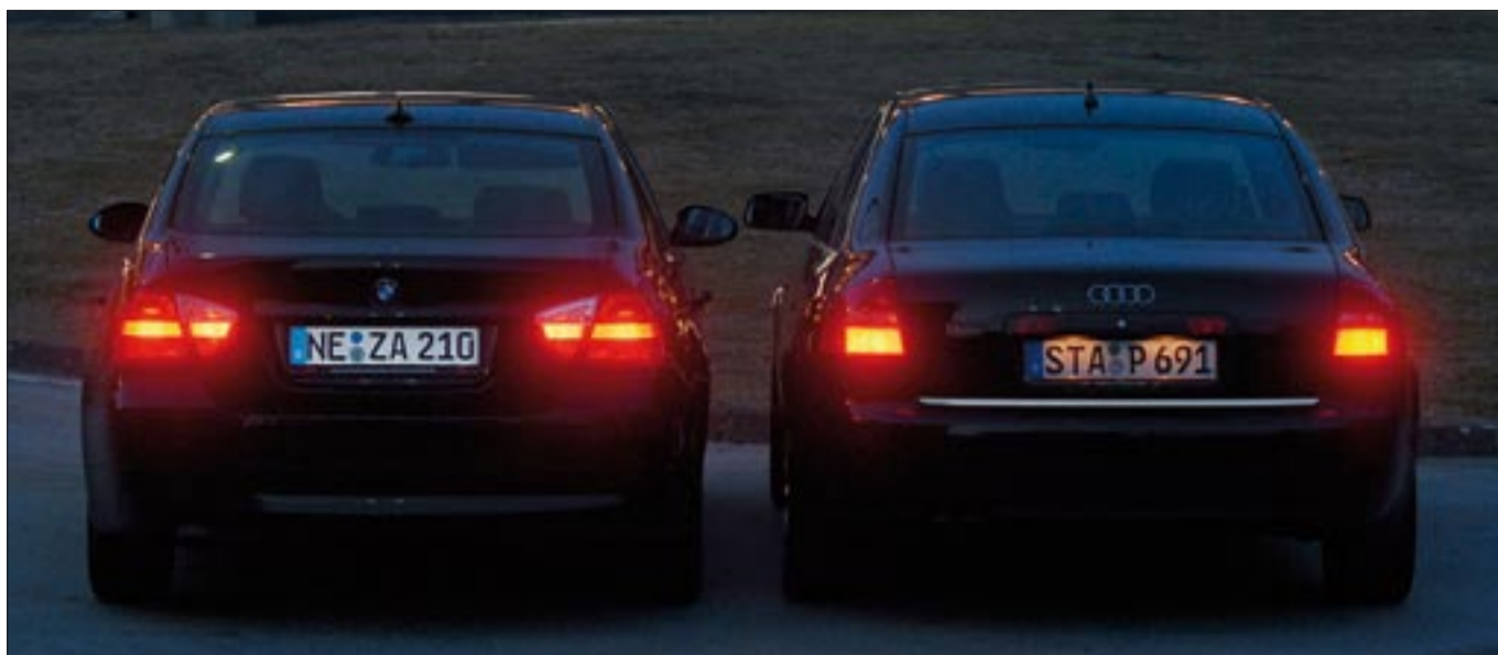
La preuve par l'image : la plaque minéralogique en PLEXIGLAS® (à gauche) est nettement plus visible que le modèle classique (à droite).
